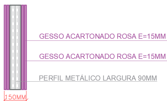
Detalhamento das paredes de enclausuramento da escada central e do antigo acesso ao PAB
