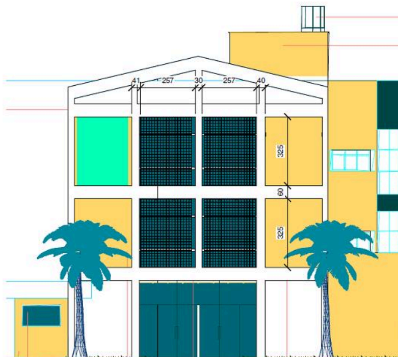
Detalhe da fachada frontal e do pórtico de concreto com preenchimento dos vãos verticais em brise colmeia
