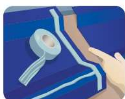
Aplicação correta da fita de vedação e do parafuso de fixação das telhas
