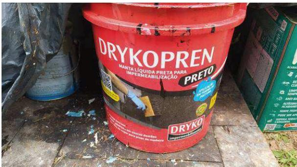
Figura 52C: Produto utilizado na impermeabilização das marquises
