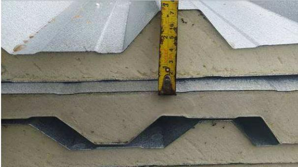
Figura 02C: Aferição da altura da telha
