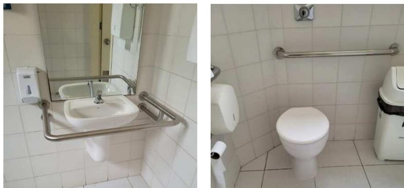
Figuras 5 – Barra de apoio no lavatório, vaso e assento sanitário.
