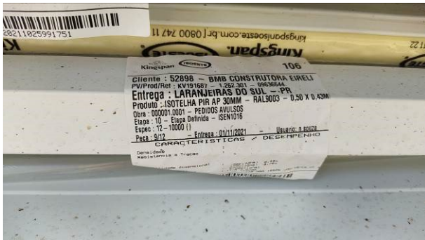
Figura 07C: Etiqueta de identificação das especificações da telha
