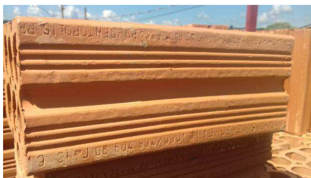
Figura 14C: Tijolo cerâmico utilizado na execução da alvenaria
