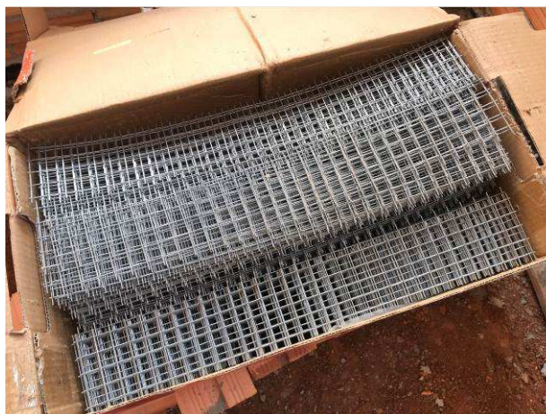
Figura 57C: Caixa de tela para prevenção de trincas
