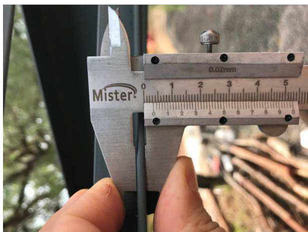
Figura 25C: Aferição da espessura de diagonal
