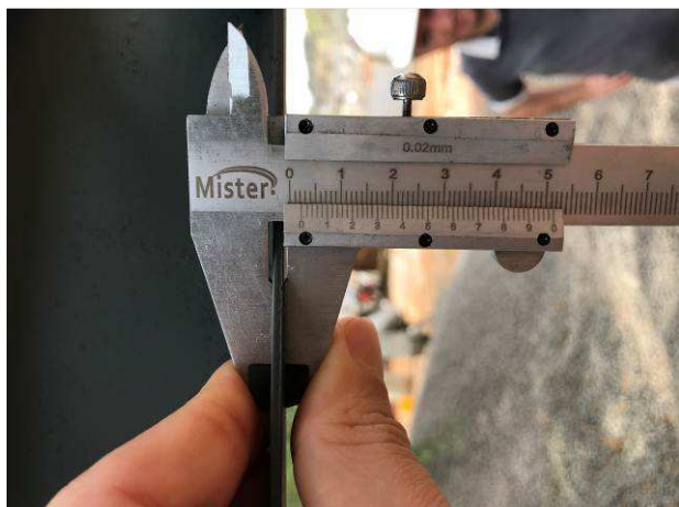
Figura 27C: Aferição da espessura de uma telha
