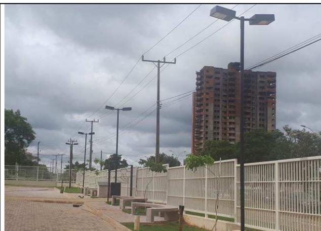
Figura 12E: iluminação externa - postes tipo pétala
