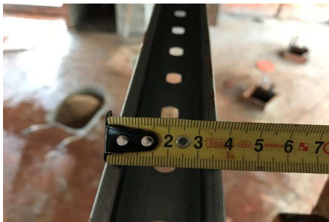
Figura 11E: Aferição da largura do perfilado - 38mm
