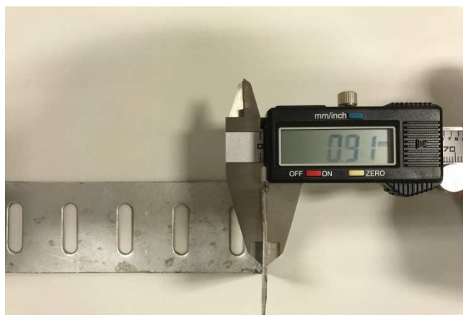
Figura 07E: Aferição da espessura de eletrocalha #200x50 - 0,9mm
