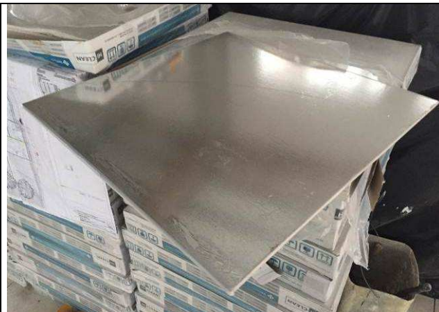
Figura 40C: Placas de forro com película de alumínio na face superior.
