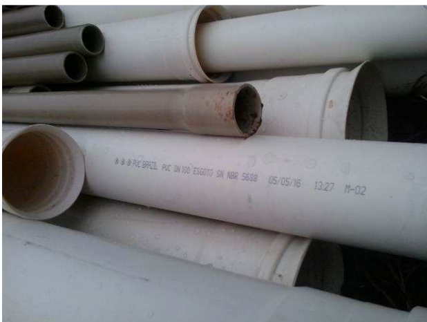
Figura 40C: Detalhe da tubulação de PVC, adquirida pela contratada (estoque).
