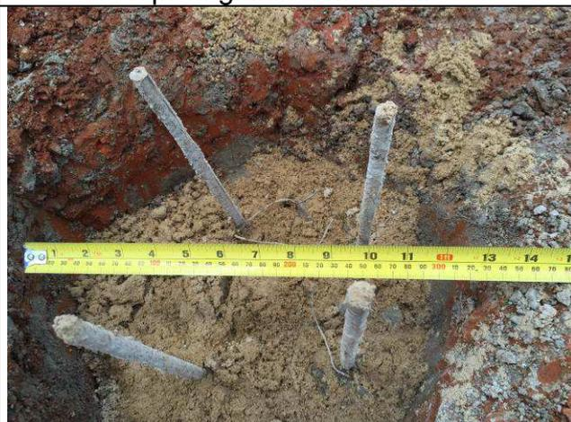
Figura 35C: Estacas concretadas - diâmetro 30cm.
