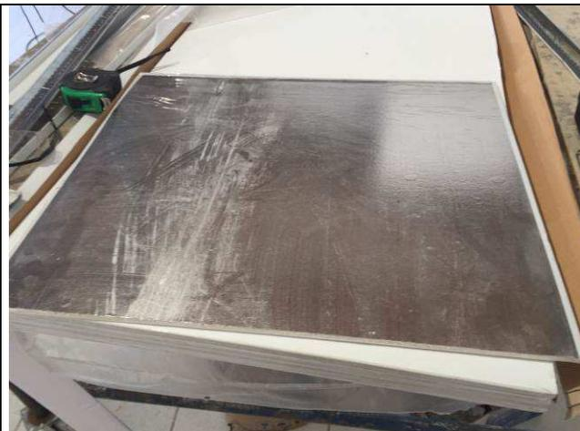
Figura 32C: Placas de forro - uma das faces com película aluminizada.
