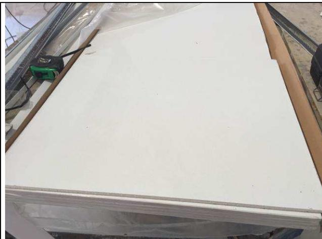
Figura 31C: Placas de forro - uma das faces com película vinílica branca.
