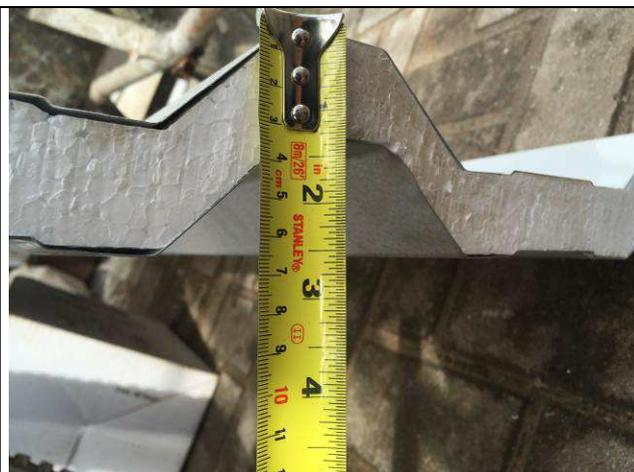
Figura 28C: Telha metálica termo-acústica.
