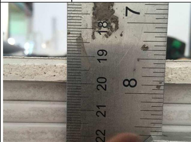
Figura 33C: Placas de forro - espessura de 9 mm.
