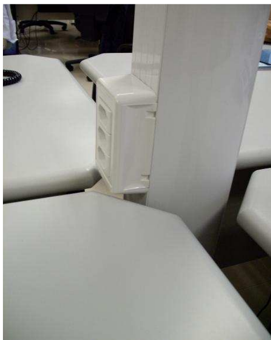
Poste técnico (Observar interrupção dos porta equipamentos para encaixe da mesa)
