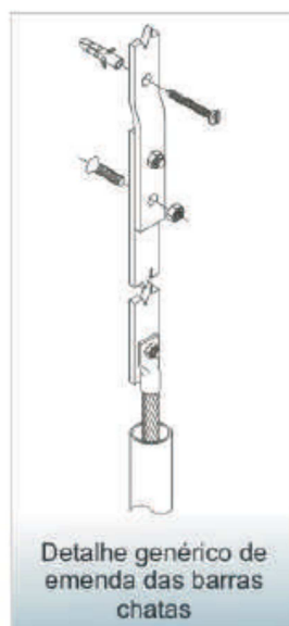
Figura 16 - Descida em barra chata de alumínio.
